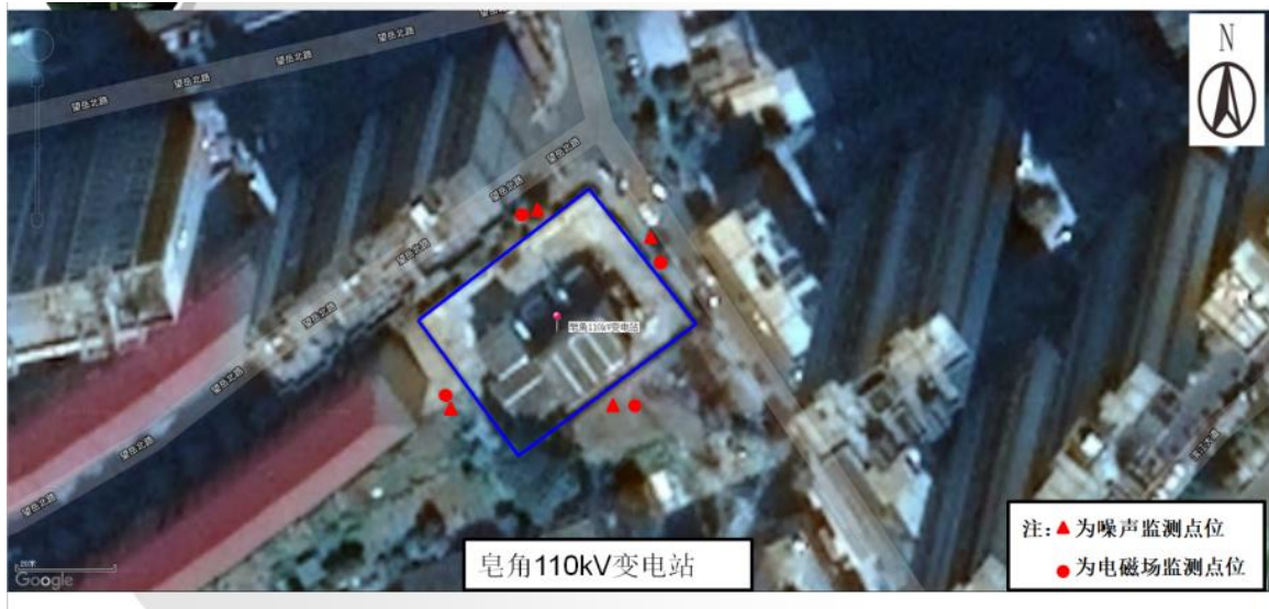
图 4 皂角 110kV 变电站平面布置及监测点位示意图
