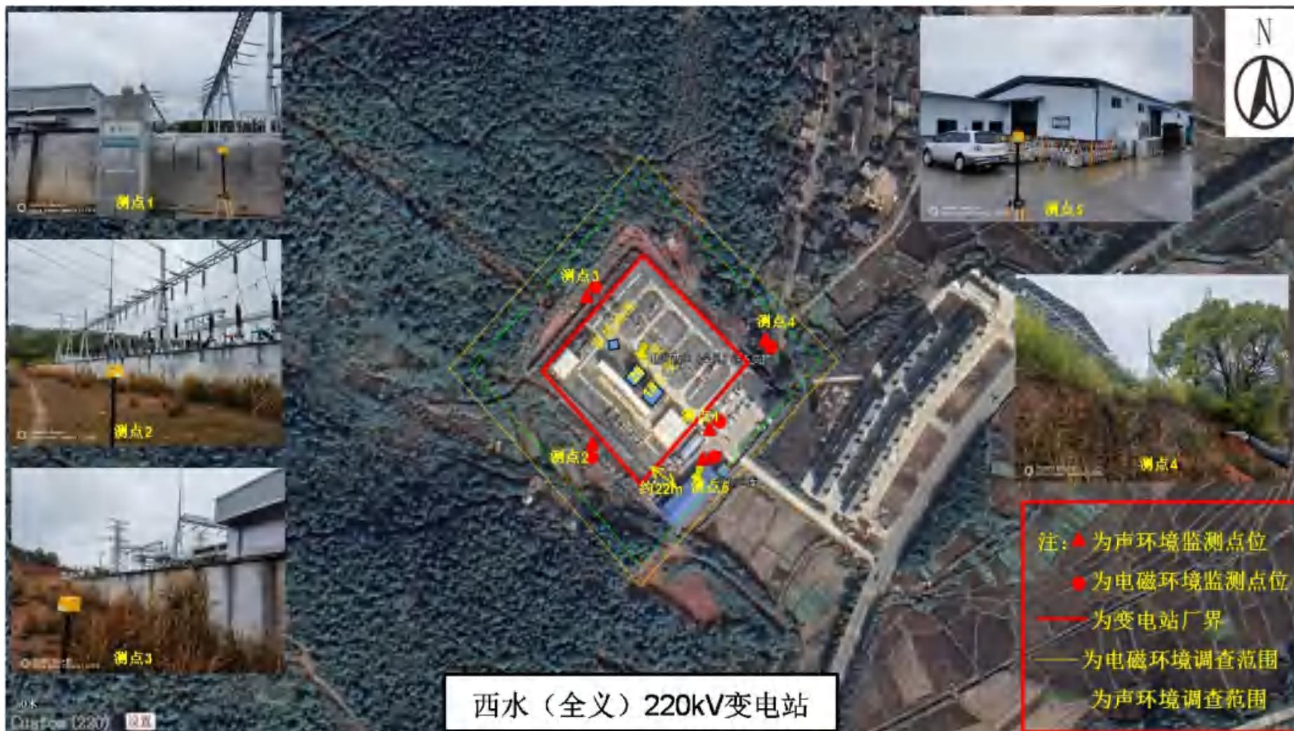
图 2-1 西水（全义）220kV 变电站监测布点示意图
