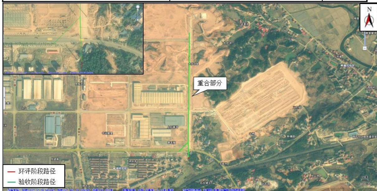
图 4-3 本工程 110kV 输电线路环评阶段与验收阶段路径对比图
